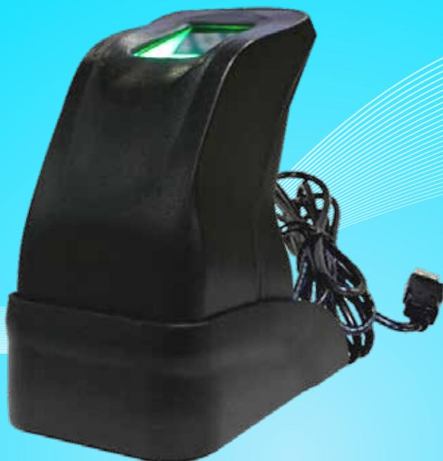
El **URU** es un dispositivo biométrico de enrolamiento de huellas dactilares con verificación de calidad de cada una de ellas.
